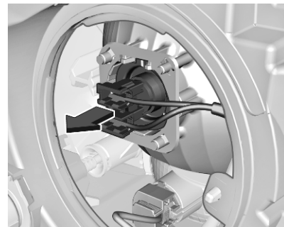
Halvljus (1) yttre glödlampa. Helljus/varselljus (2) inre glödlampa.
