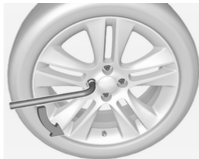
1.1. Sätt in utdragaren i det öppna spåret i centrumkåpan och ta bort kåpan från hjulet. Bilverktyg ⇨ 183.
